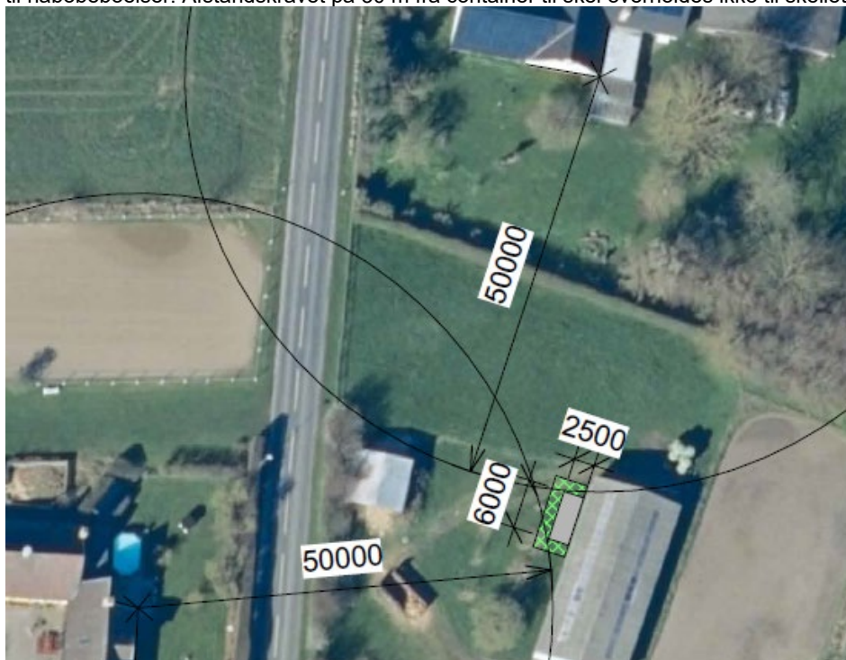
Figur 2.3. Oversigtskort, der viser at afstandskrav fra container med hestegødning overholder afstandskravet på 50 m til nabobeboelser. Afstandskravet på 30 m fra container til skel overholdes ikke til skellet mod nord.
